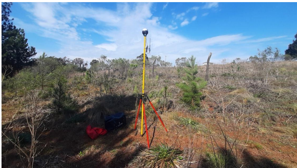
Equipamento GTK utilizado para Medição através de Georreferenciamento.
