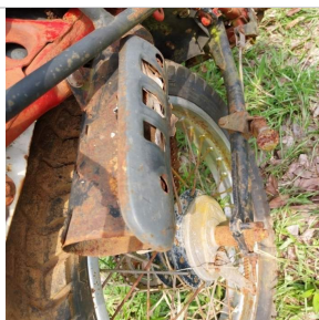
PROTECTOR DE ESCAPE: ⚠️ AVARIADO
