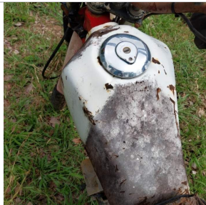
PINTURA TANQUE: ⚠️ AVARIADO
