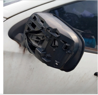
Retrovisor Lado Esquerdo: ❌ Avariado
