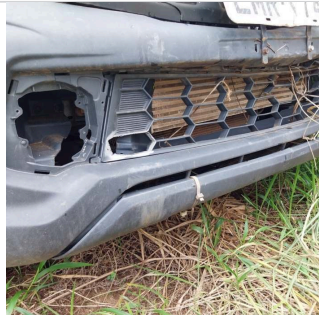
Parachoque Dianteiro: ⊘ Avariado
