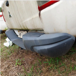
Parachoque Traseiro: ⊘ Avariado
