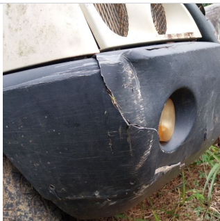
Parachoque Dianteiro: 🚫 Avariado
