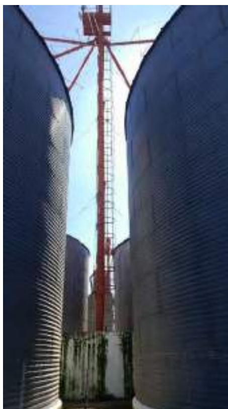
24, 25, 26 e 27 Elevador de Canecas e Conjunto de Equipamentos para Distribuição de Grãos
