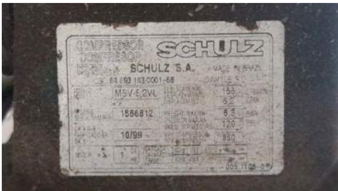
Dados de Chapa do Compressor
