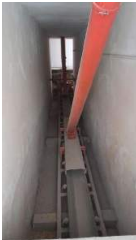
20, 21, 22 e 23 Conjunto de Equipamentos Transportadores de Correia para 04 Silos
