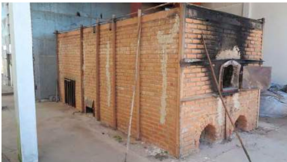
16 – Outra Vista – Gerador de Calor para o Secador – Forno a Lenha
