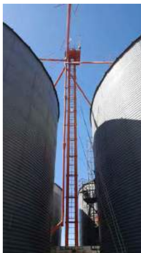
24, 25, 26 e 27 Elevador de Canecas e Conjunto de Equipamentos para Distribuição de Grãos
