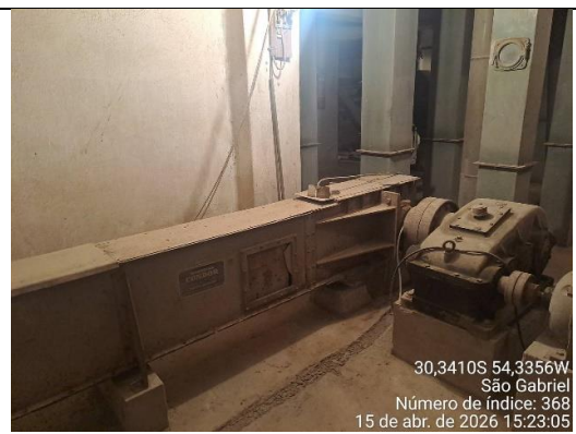
Foto 29– Transportador de Corrente (REDLER Horizontal)
