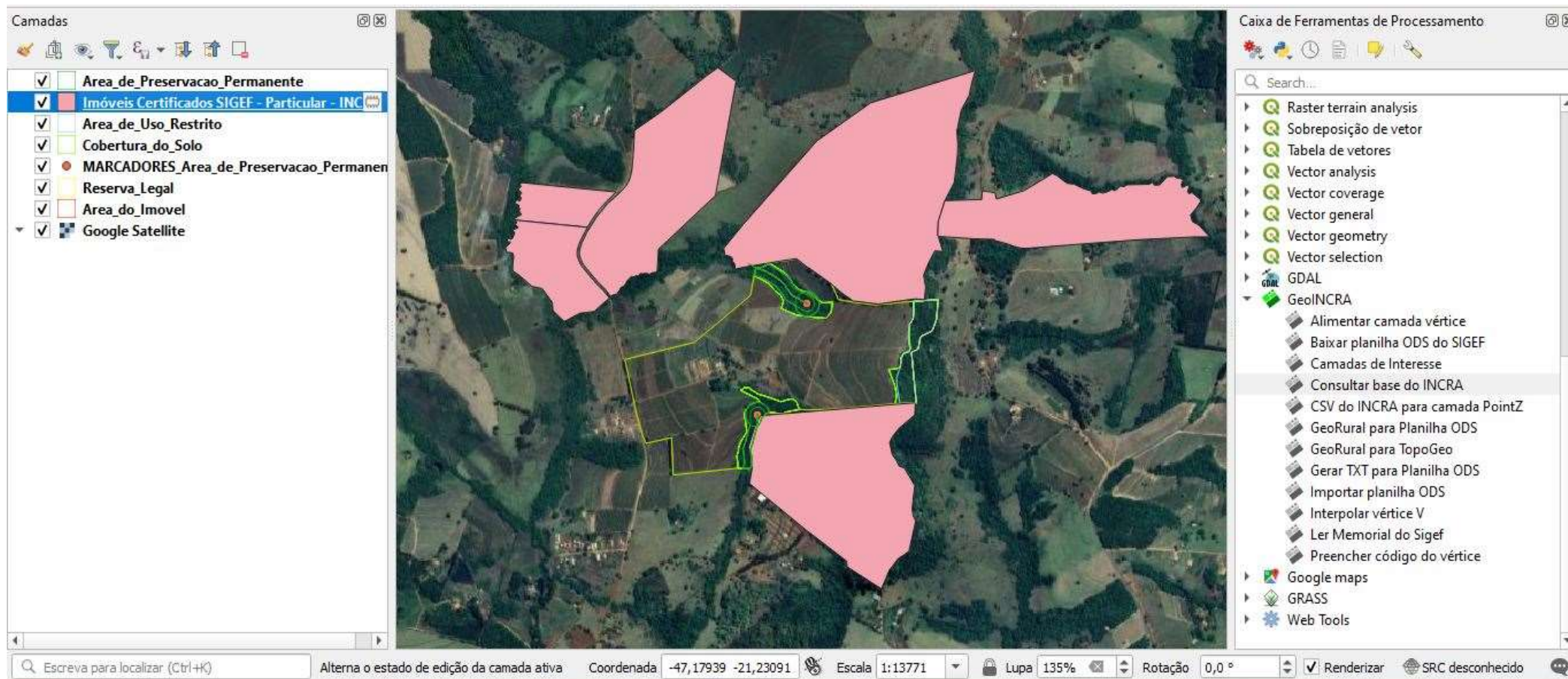
Figura 5 - LEVANTAMENTO OBTIDO NO ACERVO FUNDIÁRIO DO I.N.C.R.A NO TOCANTE A PROPRIEDADES NA REGIÃO QUE POSSUEM PROJETO DE GEORREFERENCIAMENTO, DADOS OBTIDOS NO S.I.G.E.F. (DATA REF. 08/06/2025), PROGRAMA QGIS DESENVOLVIDO PELA Open Source Geospatial Foundation (OSGeo).
