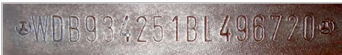
Figura 9 – Ilustra a gravação do NIV presente no veículo.
