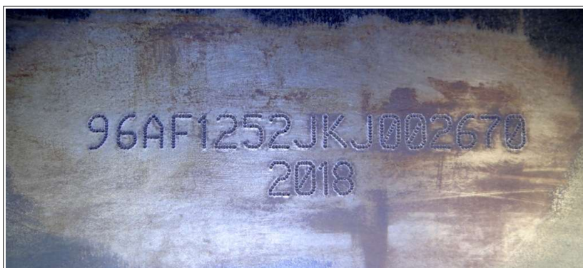
Figura 13 - Ilustra a gravação do NIV presente na longarina direita do veículo, com marcas de abrasão.
