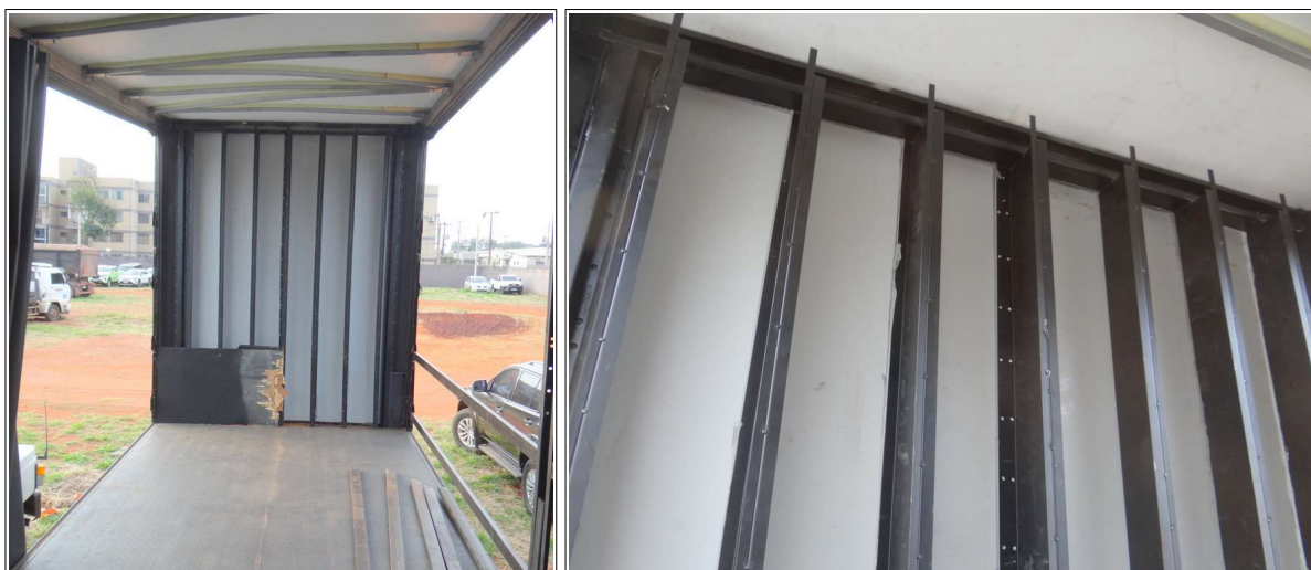
Figuras 16 e 17 – Ilustram o fundo falso confeccionado junto ao painel frontal do veículo.
