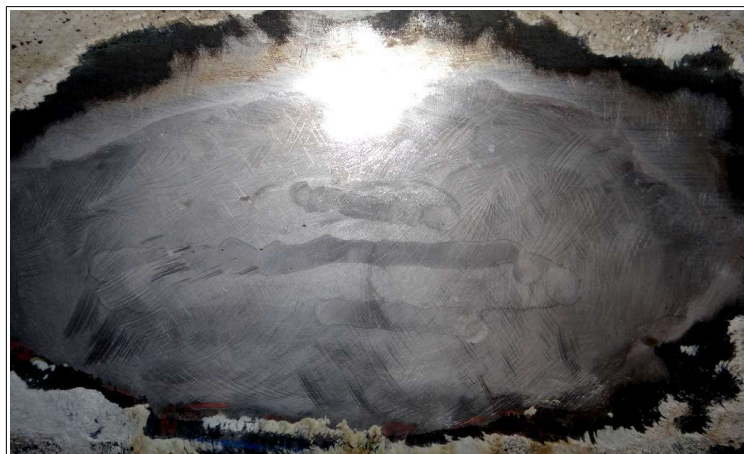
Figura 15 - Ilustra a superfície destinada à gravação do NIV na longarina esquerda do veículo após a remoção da tinta, com marcas de abrasão.
